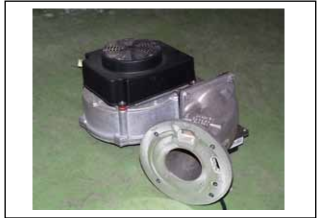
Bild: Sichtkontrolle Rückstromverhinderer
