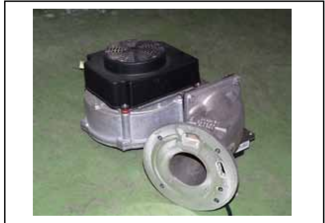
Bild: Sichtkontrolle Rückstromverhinderer
