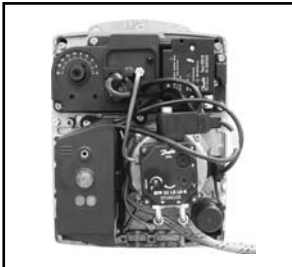
Bild: Einbaulage Brenner
