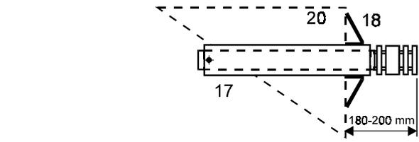
Mit 1-3% Gefälle nach außen montieren!
