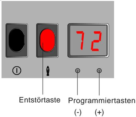
Mit den beiden Tasten unterhalb des Displays können mit folgender Vorgehensweise die Regelungsparameter verändert werden:
