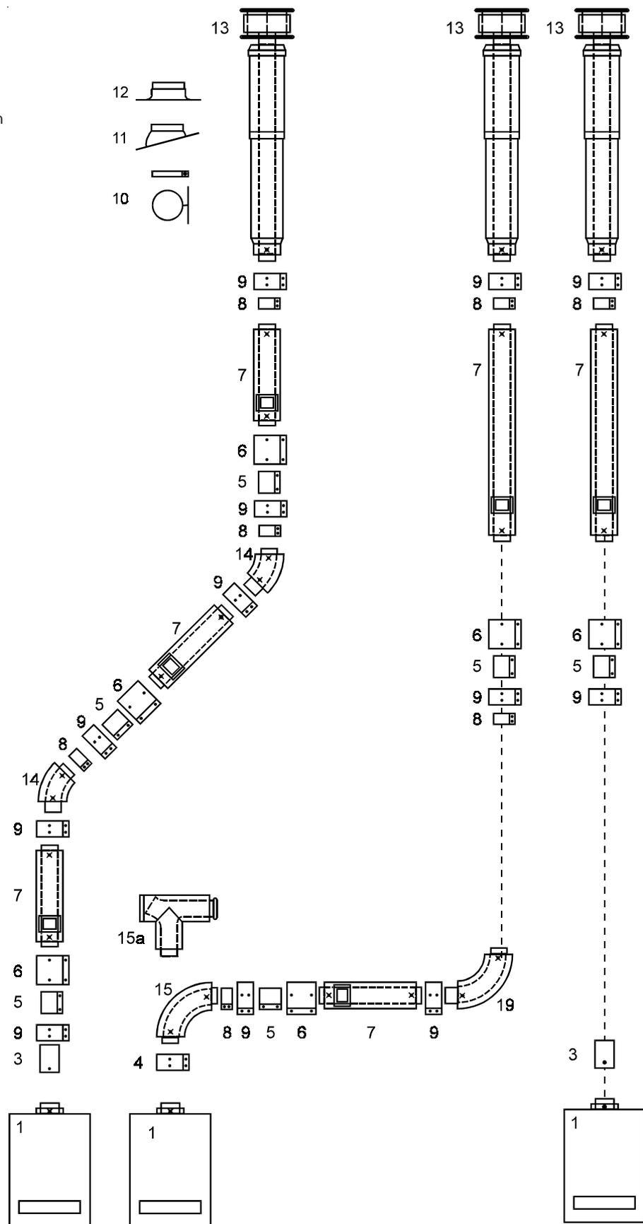
Ausgleichshülse (3) bis zum Anschlag über den Abgasanschluß an der Gastherme aufschieben und mit mindestens 1 Blechschraube sichern.
