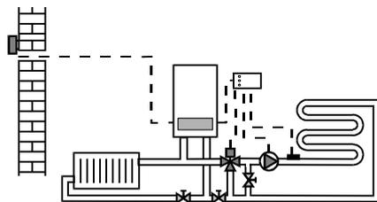
Bei Anschluß einer Fußbodenheizung ist ein 3-Wege-Mischer (Zubehör DWTM) sowie eine zusätzliche Pumpe erforderlich.
