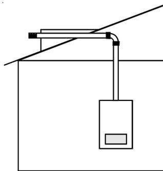
Luft-/Abgasführung waagrecht durch Schrägdach C32x (Siehe Seite 16)
