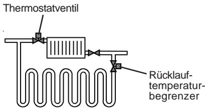
**Die Anbindung einer Fußbodenheizung ohne Mischer ist unter folgenden Voraussetzungen zulässig:**
