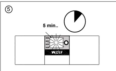
Das Display blinkt für ca. 5 Minuten – bitte während des Updates nicht aus dem Sockel ziehen, dies kann zur Beschädigung des BM-2 führen.
