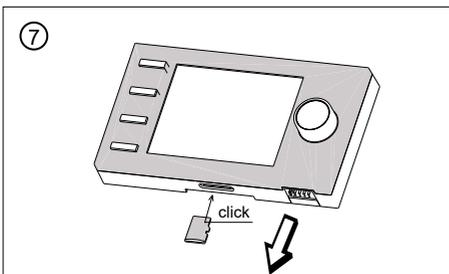
Gerät ist wieder voll funktionsfähig. Die Micro SD Card kann entfernt und später wiederverwendet werden.
