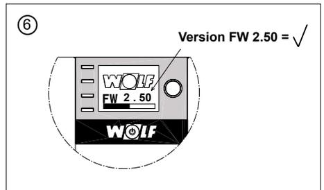
Die Software wird geladen und der Softwarestand angezeigt. Das BM-2 startet nach Beendigung des Updates automatisch neu.
