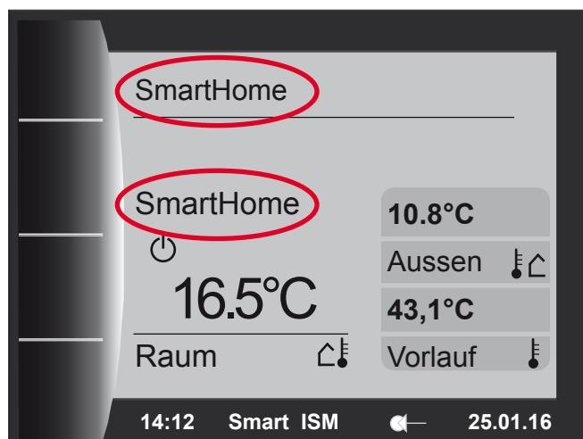
Sind nun die Komponenten aus dem Bereich der Einzelraumregelung im Einsatz und ist die Heizungsregelung des SmartHome-Systems korrekt eingerichtet, erfolgt eine automatische, bedarfsgeführte Regelung des Heizsystems bzw. der einzelnen Heiz- und Mischkreise. Dabei wird die Vorlauf-(soll)temperatur der Kreise je nach Wärmeanforderungen der Räume geregelt. Die Wärmeanforderung wird durch intelligente Algorithmen der SmartHome-Zentrale (wibutler pro) berechnet.
