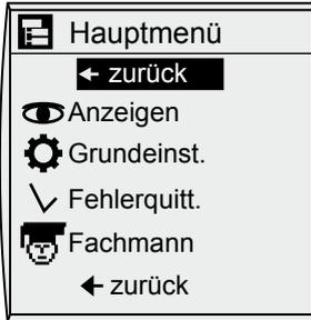
Durch Drücken des Drehknopfs gelangt man in die zweite Bedienebene, in der man durch Drehen des Drehknopfs die in der Übersicht dargestellten Menüebenen auswählen kann. Nach Auswählen des Parameters gelangt man durch nochmaliges Drücken des Drehknopfs in das Untermenü.
