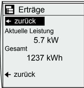
Die Anzeige zeigt die aktuelle Leistung und den Gesamtertrag der Solaranlage. Die Einheit des Gesamtertrages kann abhängig von der Einstellung „Anzeige Ertrag“ der Bedienebene Grundeinstellungen abweichen. Das Menü Erträge ist nur sichtbar wenn die Wärmemengenerfassung aktiviert wurde.
