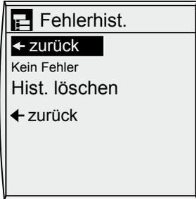
Es werden die letzten 6 aufgetretenen Fehler mit Uhrzeit und Datum des Fehlerzeitpunktes angezeigt. Über den Menüeintrag Historie löschen kann die Fehlerhistorie zurückgesetzt werden. Der Menüeintrag muss mit dem Bedienknopf ausgewählt und betätigt werden.
