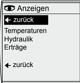
Die Bedienebene Anzeigen dient der Darstellung der wichtigsten Informationen über das System. Mit dem Drehknopf können folgende Menüpunkte zur Anzeige ausgewählt werden:
