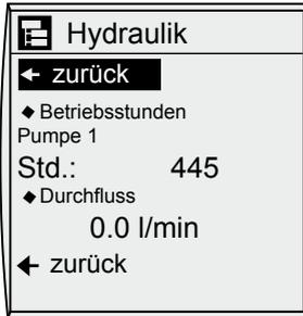
Die Anzeige stellt die Betriebsstunden zu Pumpe 1 bis 3 und den Durchfluss dar. Die Pumpen 2 und 3 werden ausgeblendet wenn sie in der eingestellten Anlagenkonfiguration nicht vorhanden sind. Der Durchfluss wird für Anlagenkonfigurationen mit interner Ertragsermittlung angezeigt.
