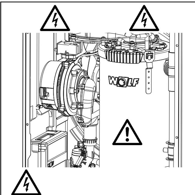
Bild: Zündtrafo, Hochspannungs-Zünderlektrode, Brennkammer
