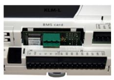
LON-Schnittstelle im freien Steckplatz so einstecken, dass eine Steckverbindung zwischen dem Verbindungsblock der LON-Schnittstelle und den Pins des Klimaund Lüftungsmoduls hergestellt wird (Verbindungsblock rastet ein).
