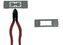
3. Innenteil der Abdeckung mit einem Seitenschneider entfernen
