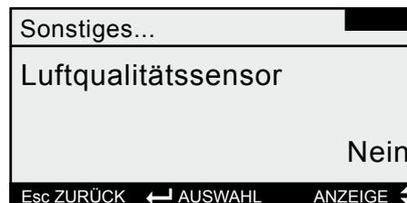
Mit **↑↓** „Luftqualitätssensor“ auswählen und mit Enter **↵** die Nachkonfiguration auswählen
